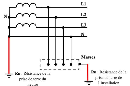
La protection est assurée par un **dispositif différentiel**
