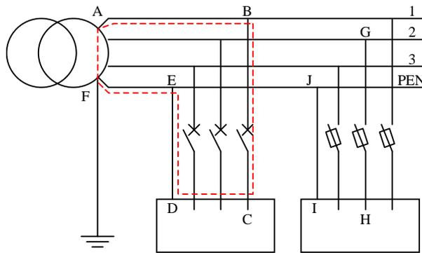
On donne  $L_{BC} = L_{ED} = 100$  m (câble en cuivre  $\rho = 2,25 \cdot 10^{-8} \Omega\text{m}$ )
