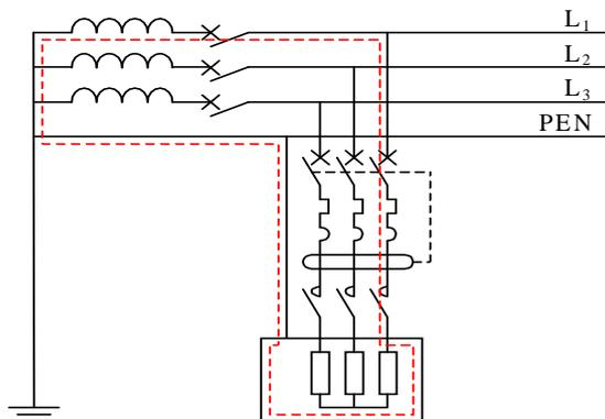
2. Indiquer en rouge la boucle parcourue par le courant de défaut  $I_d$  si un défaut apparaît entre la phase  $L_1$  et la masse du récepteur.
