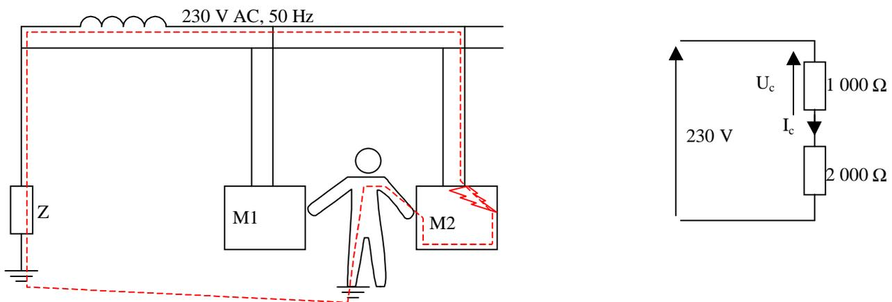
2. Déterminer la tension de contact subit par l'homme par rapport au sol lorsque la machine M2 est en défaut d'isolement.
