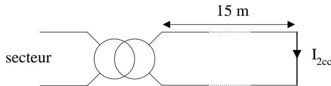
Le câble de ligne en cuivre a une section de  $1,5 \text{ mm}^2$ .
