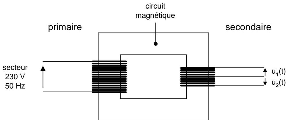
1- Quel est le rôle du circuit magnétique d'un transformateur ?
