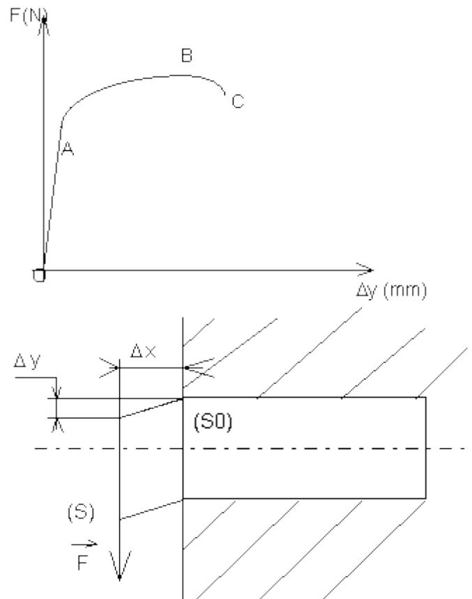
◇ **Zone OA** : c'est la zone des déformations élastiques. Si l'on réduit la valeur de  $F$  jusqu'à une valeur nulle, l'éprouvette retrouve sa forme initiale.
