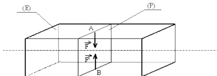
Sous l'action de ces deux forces la poutre tend à se séparer en deux tronçons **E1** et **E2** glissant l'un par rapport à l'autre dans le plan de section droite (P).
