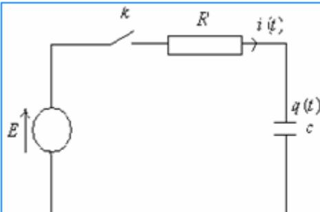
نركب في الدارة الكهربائية جاته مكثف غير مشحون ثم نغلق قاطع التيار  $k$  عند اللحظة  $t = 0$
