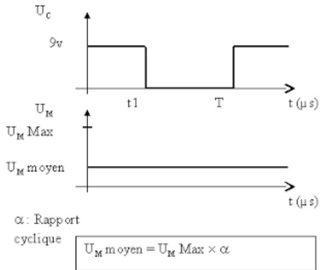
le hacheur est utilisé pour générer une tension continue réglable en modifiant la valeur moyenne de la tension d'entrée. est par la suite il permet de varier la vitesse de rotation d'un moteur à courant continu (asservissement ou régulation)
