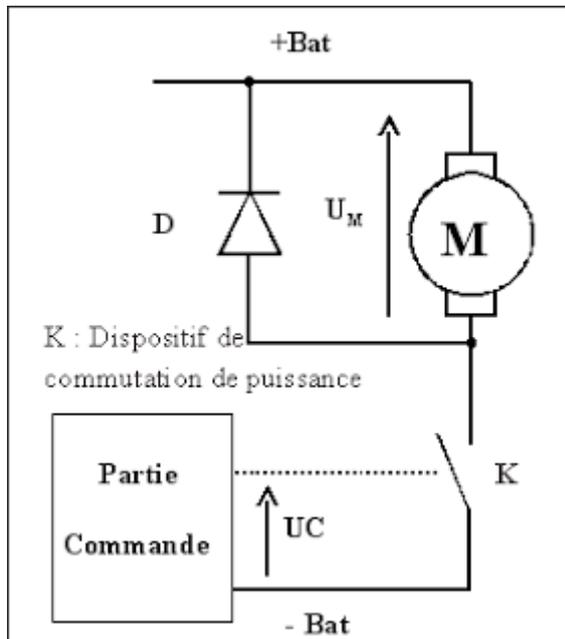
Si la tension délivrée en sortie est inférieure à la tension appliquée en entrée, le hacheur est dit **dévolteur**. Dans le cas contraire, il est dit **survolteur**. Il existe des hacheurs capables de travailler des deux manières
