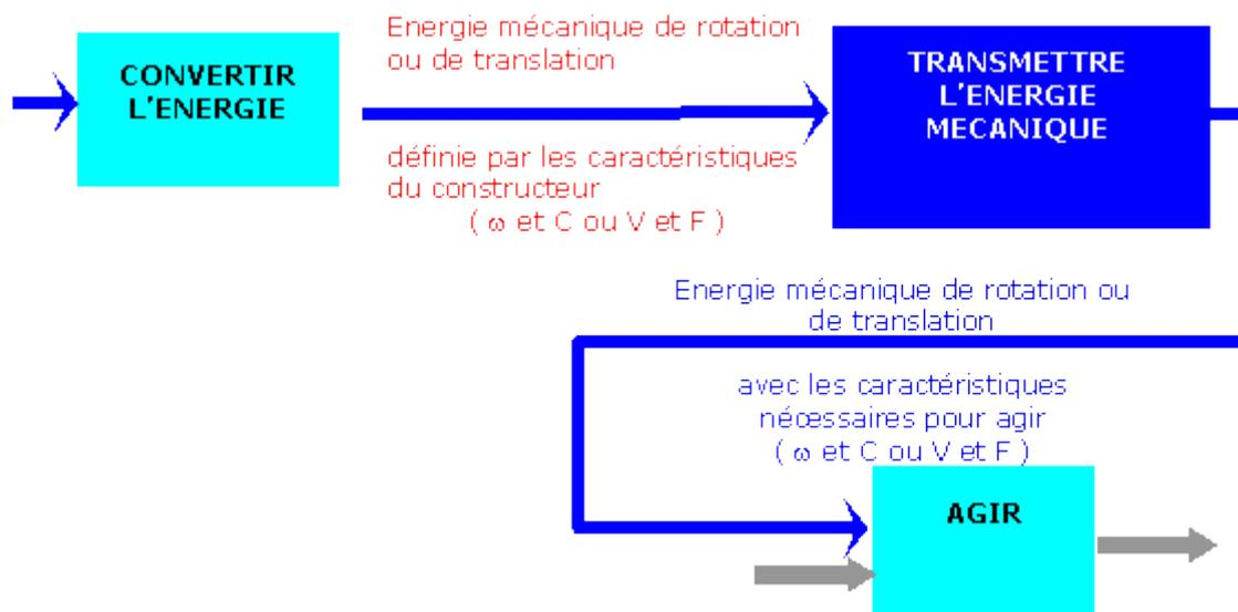
Dans la plupart des produits, il apparaît nécessaire **de transmettre l'énergie mécanique** en sortie du convertisseur ( actionneur ) au besoin en énergie mécanique pour pouvoir agir ( vitesse, effort, nature du mouvement ).
