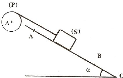
نعتبر بكرة متجانسة (P) شعاعها  $r = 4 \text{ cm}$  قابلة للدوران حول محور ( $\Delta$ ) أفقى ثابت يمر من مركزها ، عزم قصورها بالنسبة للمحور ( $\Delta$ ) :  $J_{\Delta} = 2,4 \cdot 10^{-4} \text{ kg.m}^2$ .
