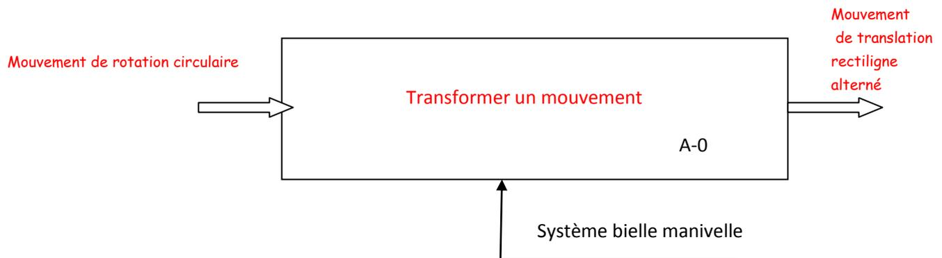
3) Identifier les différents éléments composant ce système bielle manivelle en fonction des termes généraux définis ci-dessous.
