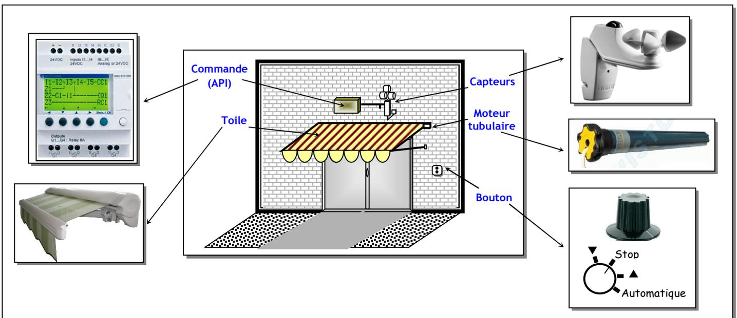
Le schéma complet de la commande du système est donné à la page 9. Pour être traitées par l'API, les informations Vent/Soleil ainsi que les commandes manuelles doivent être adaptées aux niveaux de tensions acceptables par l'API.
