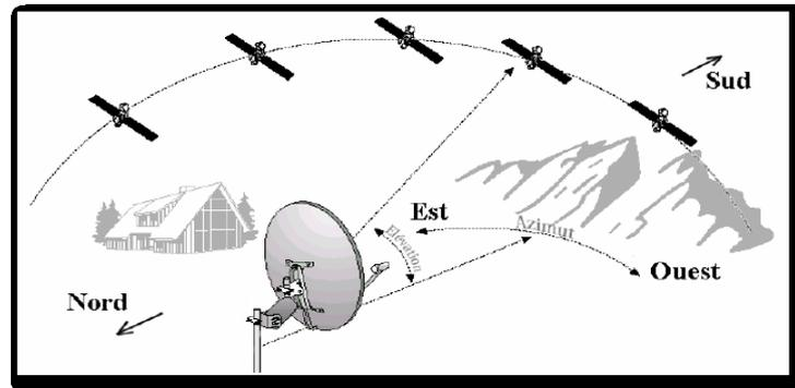
Quelques solutions techniques sont proposées dans le commerce pour pouvoir capter par la même parabole les émissions de plusieurs satellites. Parmi ces solutions, il ya celle qui consiste à équiper la parabole d'un moteur d'orientation automatique (parabole motorisée).
