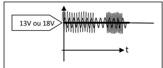
Pour pouvoir traiter les signaux de commande, il faut d'abord les extraire. On utilise alors la fonction "Filtrage" qui permet d'extraire du signal véhiculé par le câble coaxial, le signal "DiSEqC" de commande de déplacement de la parabole.
