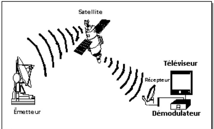
Il existe plusieurs satellites tournant autour de la terre ; de ce fait, l'antenne parabolique de réception doit être orientée dans la direction du satellite désiré selon l'implantation géographique du point de réception :
