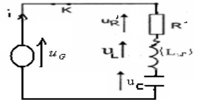
$$: \text{مع } k.i = R'i + r.i + L \cdot \frac{di}{dt} + \frac{q}{C} \quad : \text{أي} \quad u_G = u_R + u_L + u_c$$
